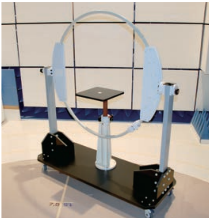
JSE-LLA-1 1m \phi ラージループアンテナ
